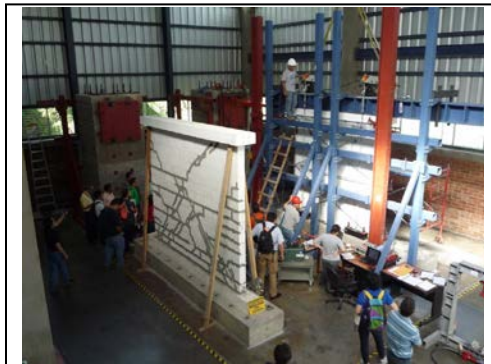
写真1: コンクリートブロックを用いた 枠組組積造実大壁試験体(右側の白い部 分)の加力準備(UCA 実験棟)
